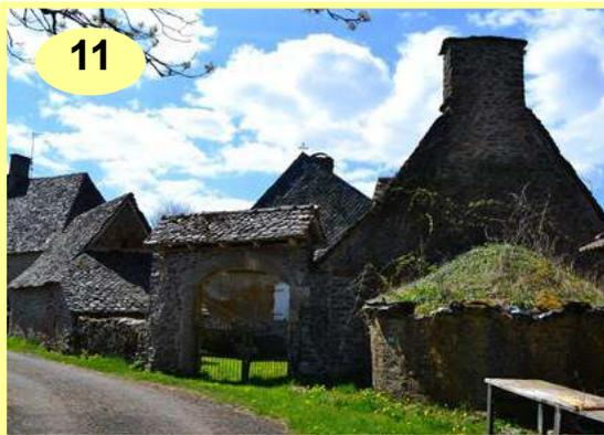
**Ensemble remarquable de bâtiments** qui comprend plusieurs maisons et annexes entourées d'un muret et clos par un portail surmonté d'un porche. **Ce porche** est ouvragé, il est bâti en pierres de taille et surmonté d'un toit à 2 pans couvert en lauzes de schiste.
